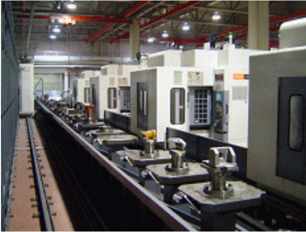
figuur 4 Voorbeeld van een palletbaan
