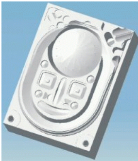
figuur 6 Voorbeeld van een afnamewerkstuk voor een 5-assige freesmachine
