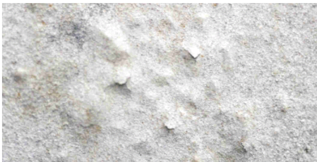
figuur 10 Ontstaan van kratertjes als gevolg van interlamellaire scheuren die de TSA-laag opdrukken
