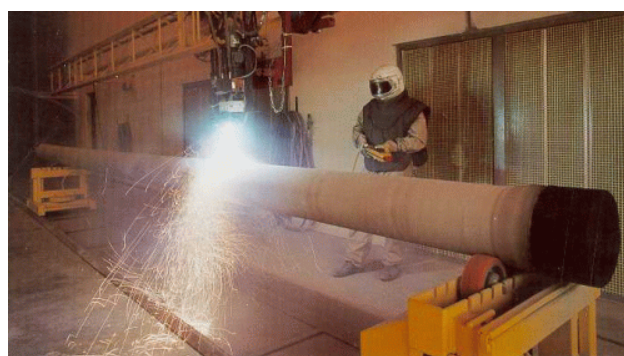
figuur 2 Het opspuiten van een TSA-laag
