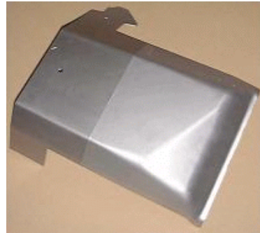
figuur 18 Onderdeel van een wielkast (Lamborghini) geperst uit een aluminium 'tailor made blank' EN AW-6016 met diktes van 2,7 mm en 1,3 mm
