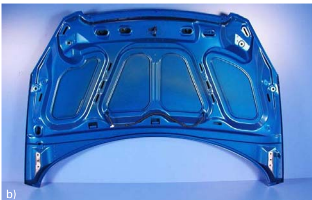
figuur 17 Motorkap van de Peugeot 307. Buitenkant (a) en binnenkant (b). Buitendeel EN AW-6016 T4. Binnendeel EN AW-5182 O. Gewicht 8,2 kg
