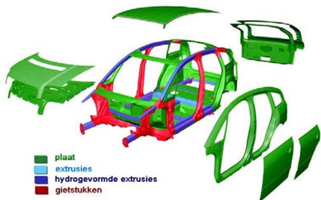
figuur 16 Spaceframe van de Audi A2
