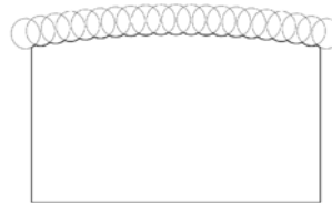
figuur 7 Het vormen van een contour door het laten overlappen van pongaten
