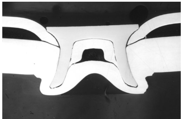
figuur 8 Microscopische foto van een ponsklinkverbinding
