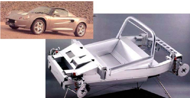
figuur 3 Lotus Elise: verlijmd aluminium frame
