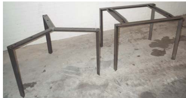
figuur 7.2 Pootjukken opgebouwd uit ongelijkzijdige driehoekige buis (lange zijde \approx 68 mm, 2 korte zijden \approx 54 mm). Bij de vierpoot tafels vormt één pootjuk de twee poten aan de zijde van een tafel. De jukken worden verbonden door twee liggers. Op de liggers wordt het blad gemonteerd. Bij de driepoot tafels worden drie pootjukken verbonden met een koppelstuk. Het blad wordt rechtstreeks op de jukken gemonteerd. De tafels zijn in drie uitvoeringen verkrijgbaar: vaste hoogte, hoogte instelbare en hoogte verstelbare uitvoering. De hoogte verstelling wordt gerealiseerd door een aluminium inschuifpoot in de pootjukken
