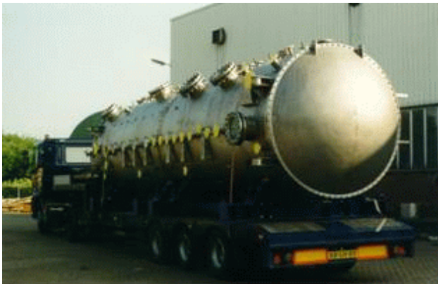
figuur 8 Kolom in 13 mm dik technisch zuiver titaan grade 2 (Oostendorp Apparatenbouw, Tiel); Lasproces plasmalassen
