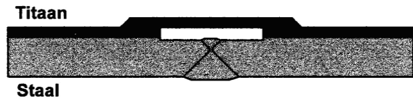
figuur 6 Lasverbinding in met titaan beklede staalplaat
