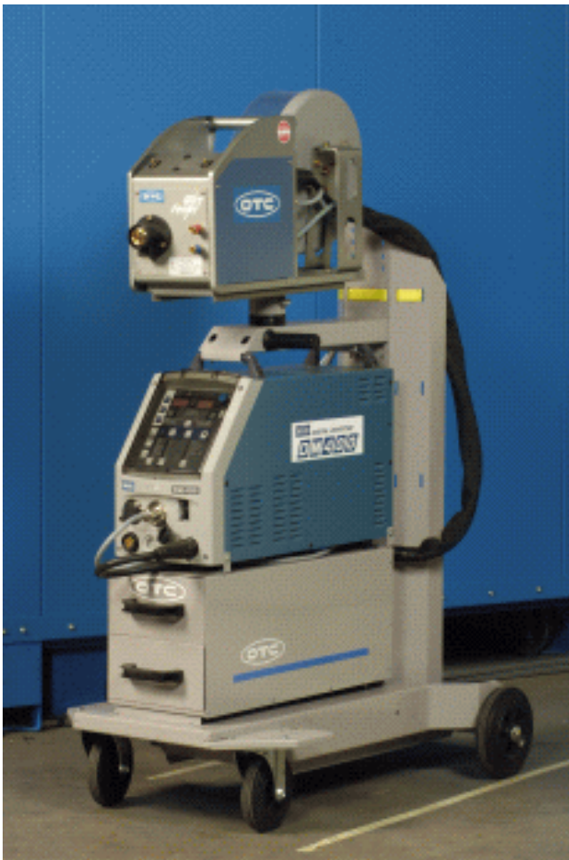
figuur 3.10 Inverter stroombron (OTC)
